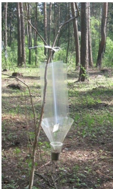
Рис. 1. Барьерная феромонная ловушка для отлова короеда-типографа
